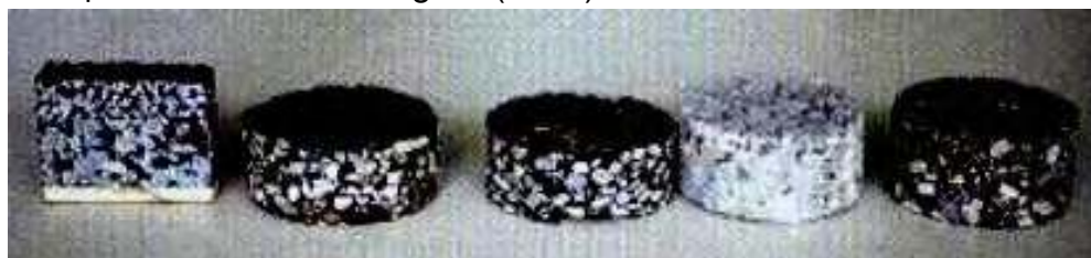
Figura 52 Amostras de superfícies para rodovias, da esquerda para a direita: camadas gêmeas de asfalto poroso com revestimento de borracha; camada única de asfalto poroso com revestimento de borracha; asfalto poroso; concreto poroso; asfalto denso.
