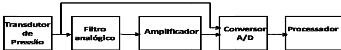
Diagrama 1: Sistema de aquisição ou medição de sinais oscilométricos
