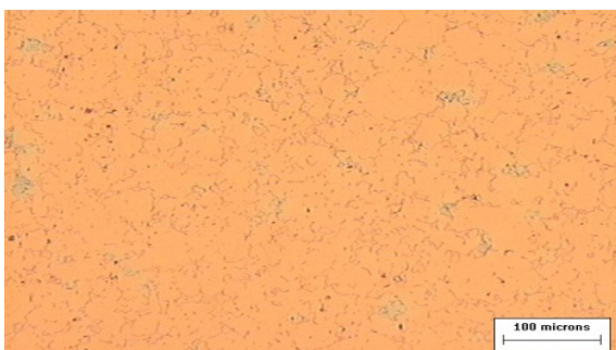
Fig.3 Liga Cu-1.0%Ni-0.5%Cr, compactada a frio; sinterizada a 1053K por 5.400s; homogeneizada a 773K por 21600 s (Micrografia óptica).
