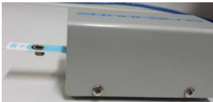
Figura 6: Fotografia do eletrodo impresso de carbono, contendo o nanomaterial híbrido com pequeno ímã acoplado na sua extremidade.
